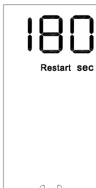
Estado de protección del compresor
