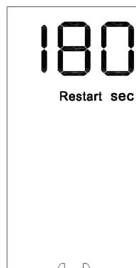
Stan ochrony sprężarki
