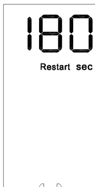
Režim zaštite kompresora
