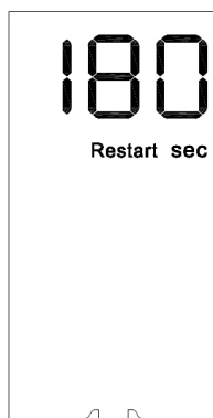
Stav ochrany kompresoru
