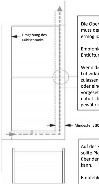
Draufsicht auf den Hinterlüftungsspalt
