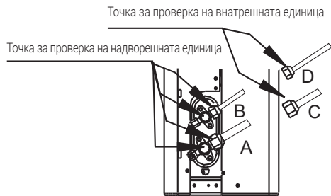
A: Стоп-вентил за низок притисок B: Стоп-вентил за висок притисок C и D: Навртки за проширување на внатрешната единица
