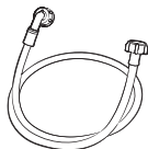
Crevo za dovod hladne vode
