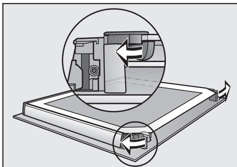
■ Oba zatvarača za stakla vrata otvorite okretanjem prema spoljnoj strani.
