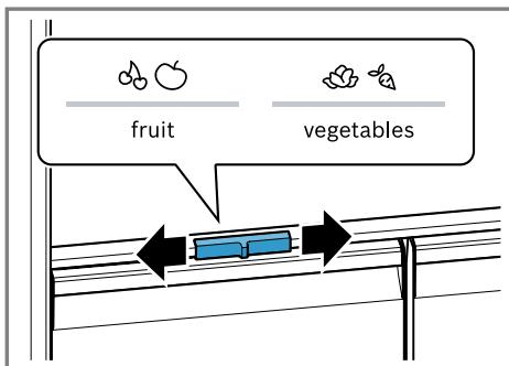
Podešavanje vlažnosti vazduha u posudi za voće i povrće u skladu sa vrstom i količinom namirnica koje treba skladištiti pomoći pomeranja regulatora za vlažnost:
