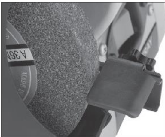
Slika 2. Postolje instalirano i postavljeno blizu brusnog točka
