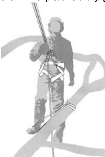
SB3 - Primer preusmeravanja glavne linije preko dodatnog ankera
