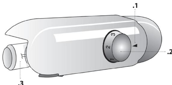
ضبط الترموموستات إلى 1/2 : الحد الأدنى من التبريد
