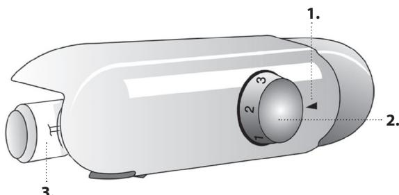
1. Oznaka nastavitev termostataTemperatura v zamrzovalniku in hladilniku
