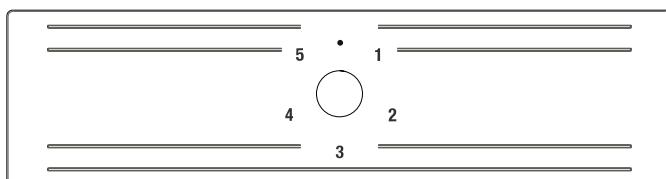
O termóstato do congelador regula automaticamente a temperatura interior dos compartimentos . Rodando o botão da posição “1” para a “5”, podem ser obtidas temperaturas mais frias.
