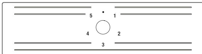
Termostat zamrzivača automatski regulira unutrašnju temperaturu odjeljaka. Zakretanjem gumba od položaja „1“ do položaja „5“ mogu se postaviti niže temperature.
