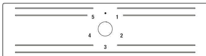
Termostat samodejno uravnava temperaturo v notranjosti zamrzovalnika.. Nižje temperature lahko nastavite z obračanjem gumba od položaja 1 do 5.
