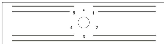
Termostat zamrzivača automatski reguliše unutrašnju temperaturu u odeljcima. Rotiranjem dugmeta za položaja 1 na položaj 5, mogu se dobiti niže temperature.
