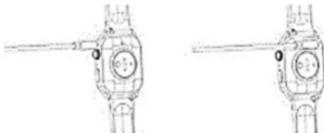
Aby se zajistil dobrý kontakt nabíjení, udržujte kovový kontakt bez nečistot, oxidace a jakýchkoli druhů znečištění. Pokud je zařízení delší dobu nečinné, nezapomeňte jej alespoň jednou za měsíc dobít.
