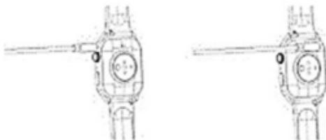
Para garantizar un buen contacto de carga, mantenga el contacto metálico libre de suciedad, oxidación e impurezas. Si el dispositivo está inactivo durante mucho
