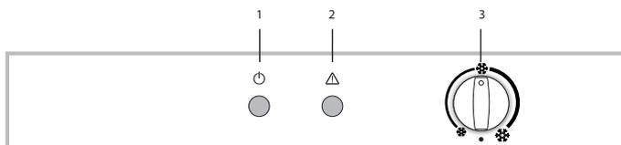
1. Svjetlo indikatora napajanja
