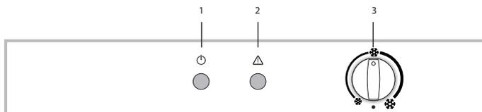
1. Indicateur de mise sous tension
