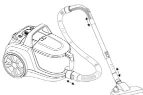
Pripojenie nasávacej hadice: Vložte nasávaciu hadicu do otvoru.
