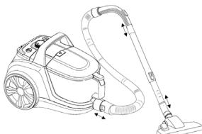
Aby podłączyć rurę ssącą, włóż rurę ssącą do otworu.
