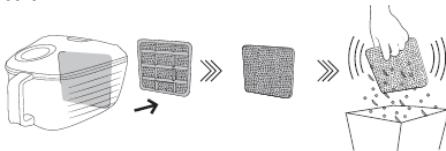
Entfernen Sie die Halterung. // Setzen Sie den unteren Rand des neuen Filters richtig in die Rillen der Halterung ein. // Schließen Sie die Halterung, indem Sie sie vorsichtig wieder eindrücken. Achten Sie darauf, dass der Filter vollständig in die Halterung passt.
