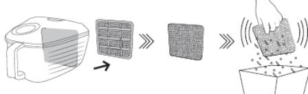
Scoateți suportul. // Introduceți corect marginea inferioară a noului filtru în fantele suportului. // Închideți suportul apăsându-l ușor din nou în poziție. Asigurați-vă că filtrul se potrivește perfect în suport.
