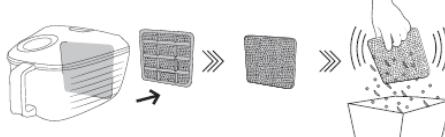
Odstranite držač. // Pravilno umetnute donju ivicu novog filtera u utore držača. // Zatvorite držač tako što ćete ga lagano pritisnuti na mesto. Uverite se da se filter potpuno uklapa u držač.
