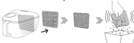
Fjern holderen. // Sett den nederste kanten av det nye filteret ordentlig inn i rillene på holderen. // Lukk holderen ved å trykke den forsiktig tilbake på plass. Forsikre deg om at filteret sitt riktig på plass i holderen.
