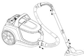
Για να συνδέσετε τον σωλήνα αναρρόφησης: εισαγάγετε τον σωλήνα αναρρόφησης στο άνοιγμα.
