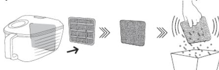
Odstranite držač. // Pravilno umetnute donji rub novog filtra u utore držača. // Zatvorite držač tako da ga lagano pritisnete na mjesto. Pobrinite se da se filter u potpunosti uklapa u držač.
