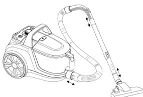
Zum Anschließen des Staubsaugerschlauchs: Stecken Sie den Staubsaugerschlauch in die Öffnung.
