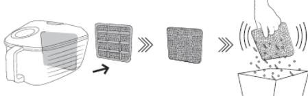
Odstraňte držák. // Vložte spodní okraj nového filtru správně do hřebenů držáku. // Zavřete držák jemným zaťažením zpět na místo. Ujistěte se, že filtr zcela zapadl do držáku.
