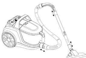
Za spajanje usisnog crijeva: umetnite usisno crijevo u otvor.
