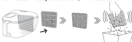
Poista pidike. // Aseta uuden suodattimen alareuna kunnolla pidikkeen harjanteisiin. // Sulje pidike painamalla se varovasti takaisin paikalleen. Varmista, että suodatin sopii pidikkeeseen kokonaan.
