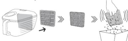
Ta bort hållaren. // Sätt in den nedre kanten av det nya filtret ordentligt i hållarens spår. // Stäng hållaren genom att trycka tillbaka den på plats försiktigt. Se till att filtret passar helt i hållaren.
