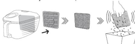
Fjern holderen. // Indsæt den nederste kant af det nye filter korrekt i holderens riller. // Luk holderen ved forsigtigt at trykke det på plads igen. Sørg for, at filteret sidder helt korrekt i holderen.
