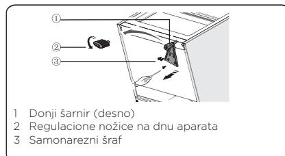
11.Premestite donji šarnir na levu stranu i pritegnite ga koristeći posebne samonarezne šrafove sa cilindričnom odnosno zaobljenom glavom. 12.Premestite pričvrsnu pločicu prednje nožice na drugu stranu i pritegnite je koristeći posebne samonarezne šrafove sa cilindričnom odnosno zaobljenom glavom. Namestite podesive donje nožice.
