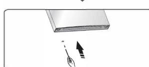
9.Premestite poklopce (odnosno čepiće) otvora za šrafove na čeonoj stranici pregradnog zida između rashladnog i zamrzivačkog dela aparata sa leve na desnu stranu (kao što to prikazuje donja slika).
