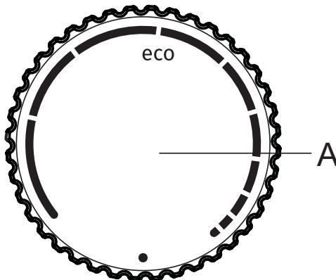
**A dugme za regulisanje temperature – uključenje/isključenje aparata**
