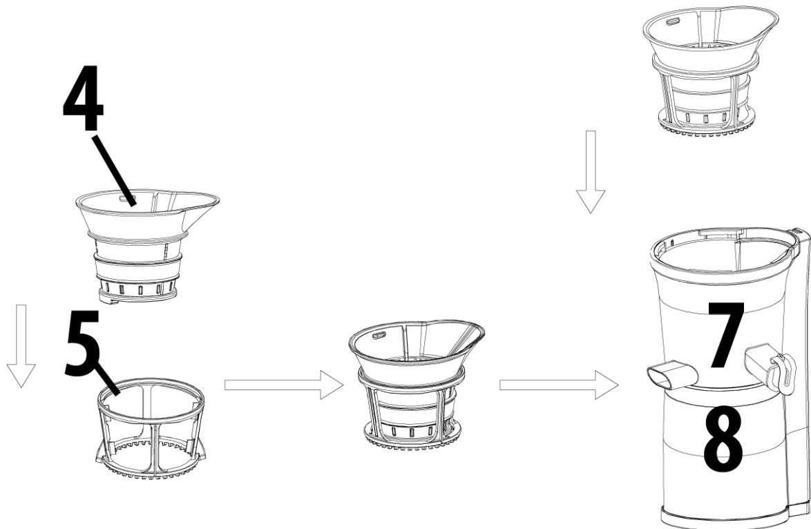
**Voor het juisen:** Steek de sapzeef (4) in het zeefframe (5) en draai hem licht, totdat het zeefframe vastklikt. Doe dan de sapzeef met het zeefframe in het zeefvak (7).
