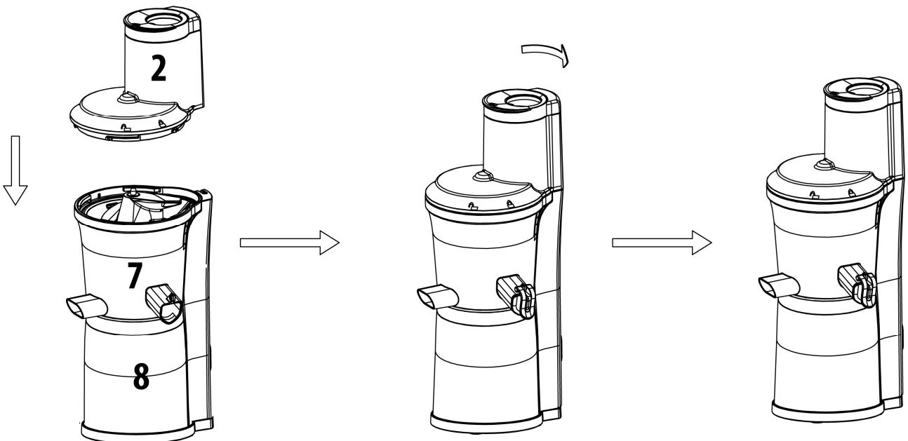
Colocar la ranura de carga (2) de forma que el símbolo de la ranura de carga quede sobre el símbolo del compartimento de tamiz (7). Presionar hacia abajo y girar a derechas, hasta que el símbolo de la ranura de carga (2) quede sobre el símbolo del compartimento de tamiz (7).
