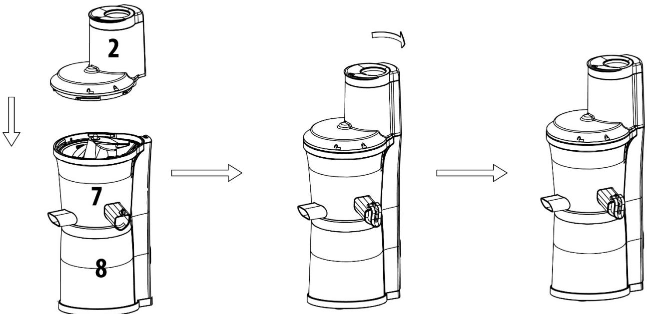
Vulschacht (2) zodanig plaatsen, dat het symbool ↗ op de vulschacht boven het symbool ↘ op het Zeefvak (7) staat. Naar beneden drukken en in de richting van de klok draaien, totdat het symbool ↗ op de vulschacht (2) boven het symbool ↗ op het Zeefvak (7) staat. Stop (1) in het deksel met de vulschacht (2) plaatsen.
