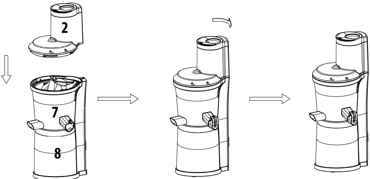
Placer la tube d'alimentation (2) de manière à ce que le symbole sur la tube d'alimentation soit placé au-dessus du symbole tamis (7). Pousser vers le bas et tournez dans le sens des aiguilles d'une montre jusqu'à ce que le symbole sur la tube d'alimentation (2) est placé au-dessus du symbole tamis (7).
