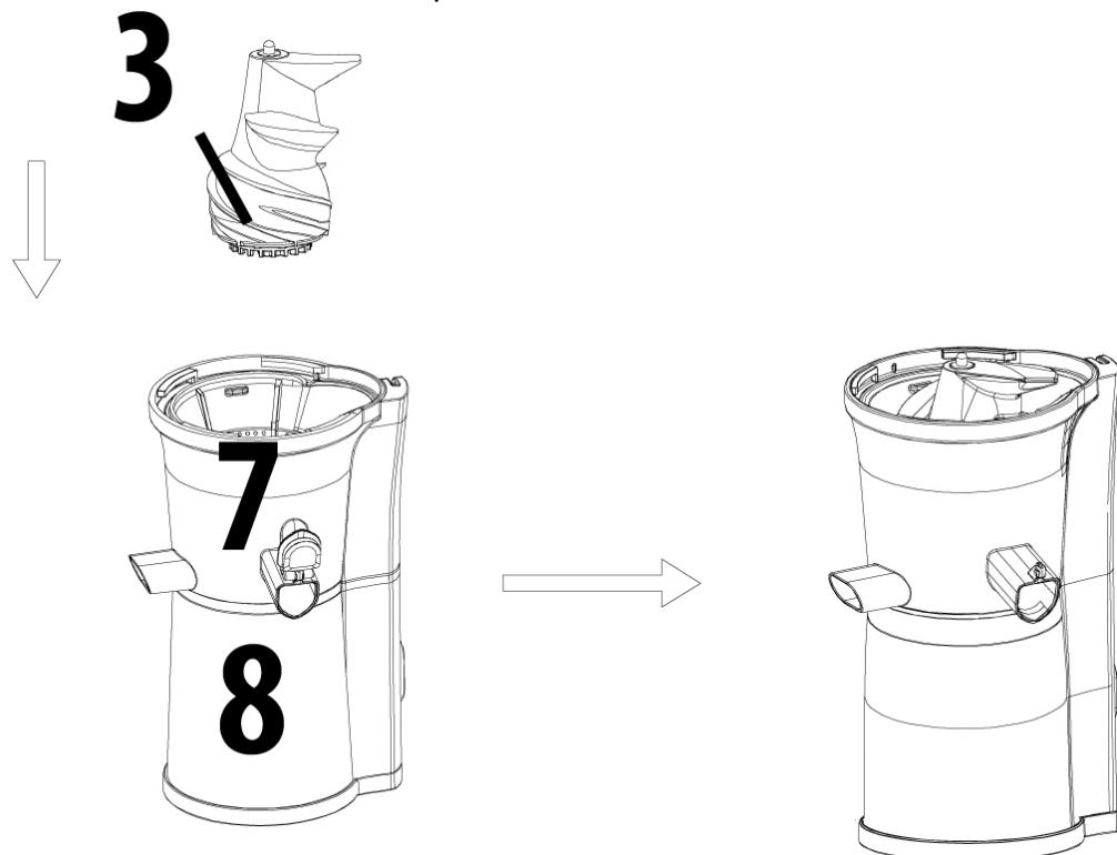
Em seguida, coloque a rosca de transporte (3) na peneira de sumo / no acessório de sorvete já instalado, pressione para baixo e rode até engatar.
