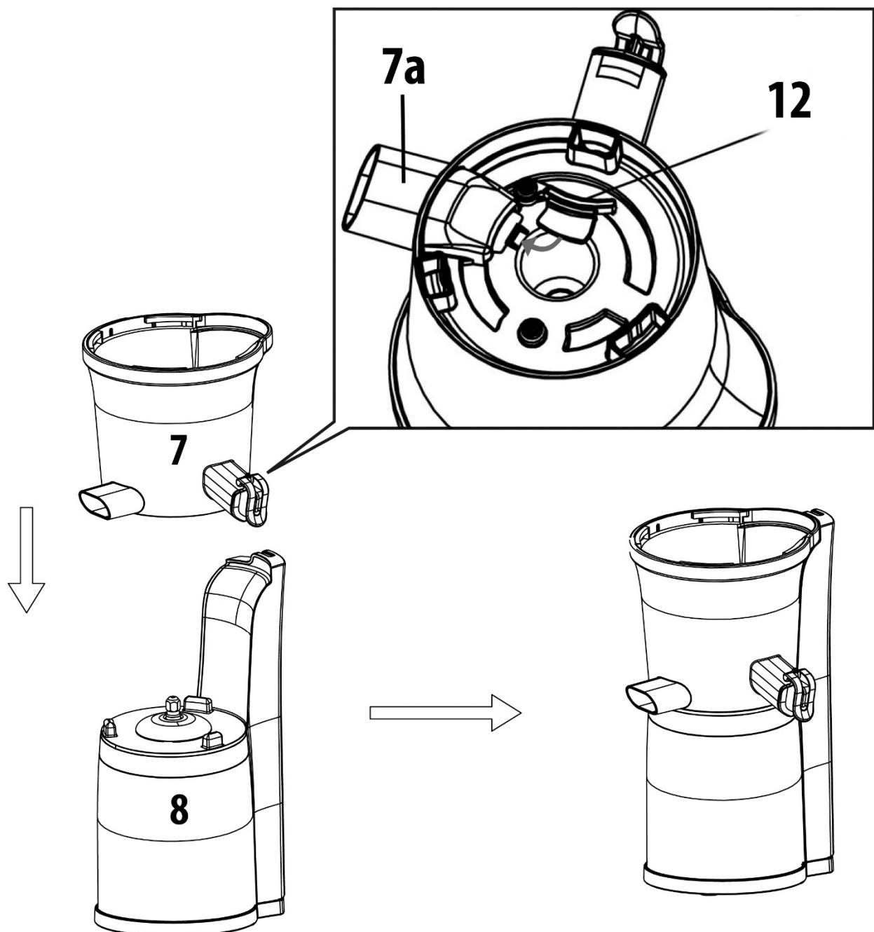
Controleer of de siliconenprop (12) in de uitloop voor het afval (7a) gedaan is, zie de onderkant van het zeefvak met uitlopen (7). Zet het zeefvak met uitlopen (7) op het motorblok (8).
