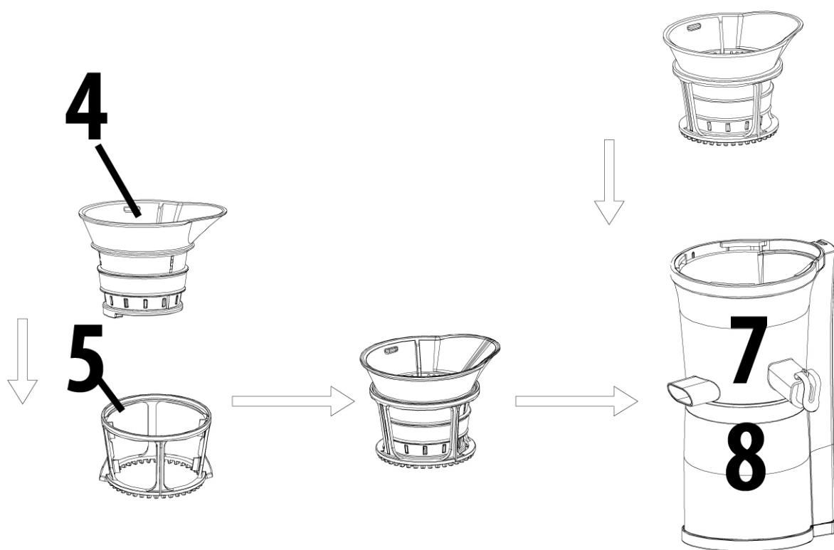
**Para exprimir zumo:** Coloque el tamiz de zumo (4) en el portatamiz (5) y gírelo ligeramente hasta que el portatamiz encaje. Seguidamente, coloque el tamiz de zumo con el portatamiz en el compartimento de tamiz (7).
