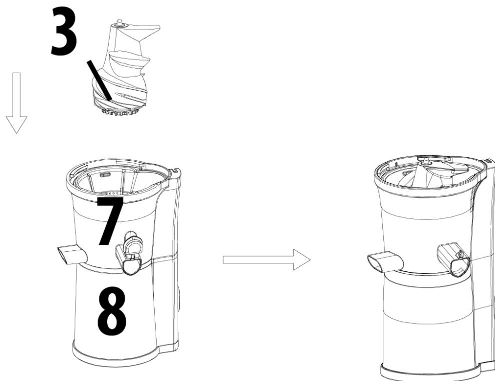
Потом поместите шнек (3) в уже установленное сито для сока / уже установленную вставку для сорбета, надавите вниз и поворачивайте, пока шнек не зафиксируется.
