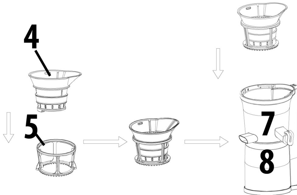
**Pour la extraction de jus :** Insérer le tamis à jus (4) dans le cadre du tamis (5) et le tourner légèrement jusqu'à ce que le cadre du tamis s'enclenche. Placer ensuite le compartiment à tamis à jus avec le cadre de tamis dans le compartiment de tamisage (7).
