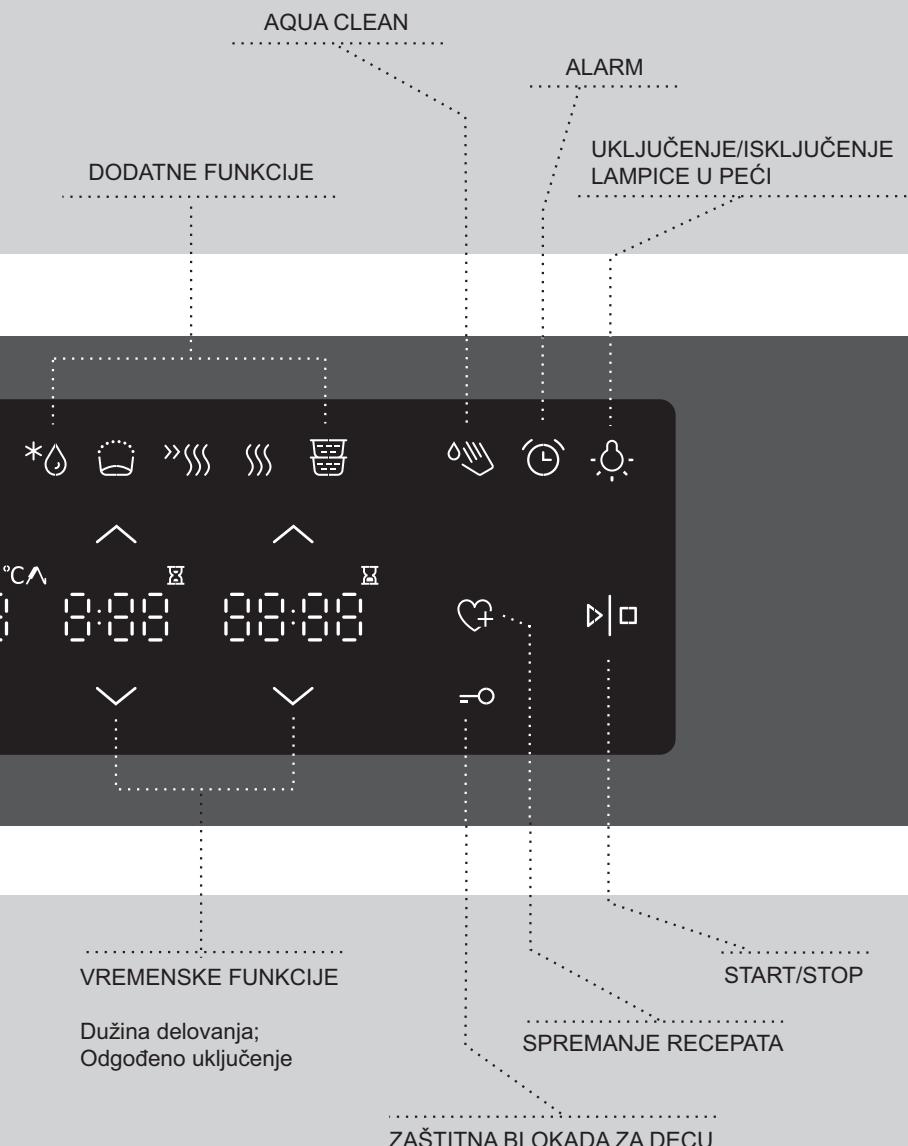
**NAPOMENA:** tasteri će bolje reagovati ako ih dodirujete čim većom površinom vrška prstiju. Svaki dodir tastera popraćen je zvučnim signalom.
