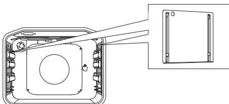
**ULOŠCI ZA JEDNOSTAVNO ČIŠĆENJE** sprečavaju na stranicama peći prskanje masnoće tokom pečenja.
