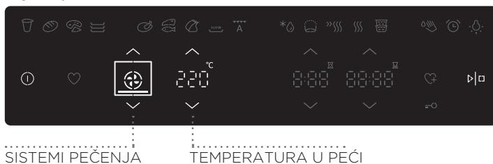
Dodirivanjem tastera ( $\nearrow$ ) i ( $\searrow$ ) izaberite sistem i temperaturu u peći.
