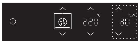
Nakon uključenja na indikatoru se pojavi natpis "**Prob**". Izaberite traženu temperaturu. Dodirnite taster START.
