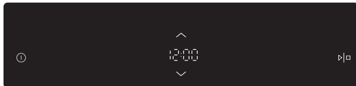
Dodirivanjem tastera (^) i (v) regulišite tačno vreme na satu. Izbor potverdite pritiskom na taster START/STOP.
