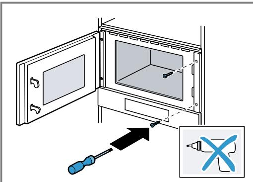
5. Otvore za vijčane spojeve prethodno napravite na strani nameštaja sa šarkama.
