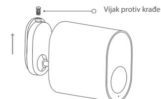
5. Pomoću vijaka postavite pločicu za postavljanje baze na zid.
