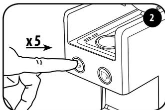
Tryk inden for 15 sekunder efter tænding 5 gange på tasten . Begge taster blinker. Det er nu muligt at ændre temperaturen som beskrevet i punkt 3 og 4.
