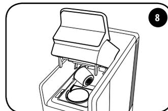
Um die leere Kapsel auszuwerfen, wird der Hebel langsam nach oben geschoben und die Kapsel automatisch in den entsprechenden Behälter ausgeworfen. Wird die Kapsel nicht ausgeworfen, muss der Vorgang wiederholt werden.
