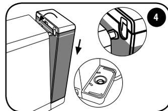
Τοποθετήστε πάλι τη δεξαμενή στις δύο σχισμές και συνοδεύστε την προς τη μηχανή μέχρι να συνδεθεί καλά. Βεβαιωθείτε ότι η δεξαμενή έχει τοποθετηθεί πλήρως.
