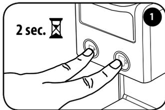
关闭机器，操作方式为：同时按住两个咖啡冲泡按键并保持2秒钟。
