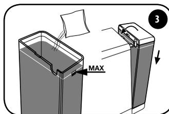
Encha o reservatório com água fresca até o nível máximo e dissolva a solução descalcificante. Reinsira o reservatório em correspondência das duas ranhuras e acompanhe-o em direção à máquina até que esteja totalmente encaixado.
