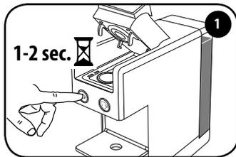
咖啡胶囊舱门打开时，通过按住两个咖啡冲泡按钮之一 1-2 秒启动机器。
