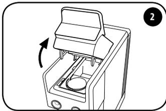
缓慢提起咖啡胶囊隔舱打开/闭合架（直到停止）。
