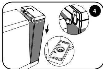
4 重新装上含除垢剂的水箱，操作方式为：对齐两个槽口，朝着机器移送，直到准确钩接。检查水箱是否完全钩接。
