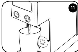
Tryk på en af tasterne ☞ eller ☞ og afvent at brygningen af varmt vand stopper. Maskinen er skyllet, når der er blevet brygget mindst 3 krus vand. Nu er maskinen klar til brug.
