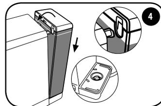
Sæt tanken i igen udfor de to åbninger og skub den mod maskinen indtil den fuldstændigt sidder fast.
