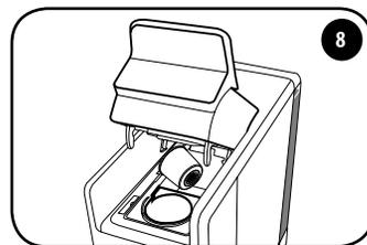
Для извлечения использованной капсулы медленно поднимите рычаг и капсула будет автоматически сброшена в специальный контейнер. Если капсула не сбрасывается, повторите действие.
