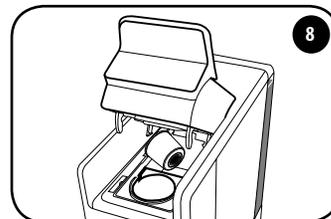
8 Para ejetar a cápsula utilizada, eleve lentamente a alavanca e a cápsula será coletada automaticamente no recipiente apropriado. Se a cápsula não for ejetada, repita a operação.
