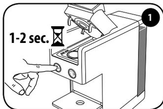
Bei geöffnetem Hebel die Maschine einschalten, indem man eine der beiden Kaffeeausgabetasten 1-2 Sekunden lang drückt. Keine Kapsel einlegen.
