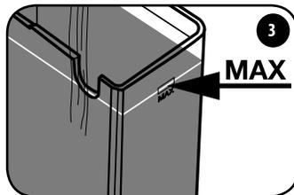
Den Wassertank bis zum maximalen Füllstand mit frischem Trinkwasser füllen.
