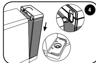
Reinsira o reservatório em correspondência das duas ranhuras e acompanhe-o em direção à máquina até que esteja totalmente encaixado. Verifique se o reservatório está totalmente encaixado.
