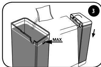
向水箱内注入干净的饮用水，直到最大刻度线，在水中加入除垢产品。
