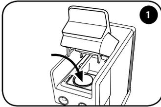
Eine Kapsel in die entsprechende Aufnahme einsetzen.
