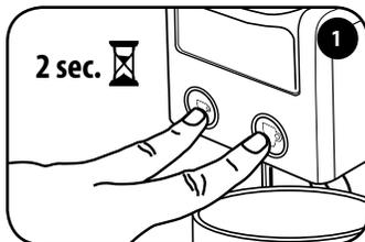
Den Hebel schließen, keine Kapsel einlegen. Die Maschine ausschalten, indem die beiden Kaffeeausgabestasten ☞ ☞ gleichzeitig 2 Sekunden lang gedrückt werden.
