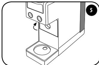
5 Coloque a grelha de apoio de chávenas na posição vertical. Encha o reservatório com água fresca potável.
