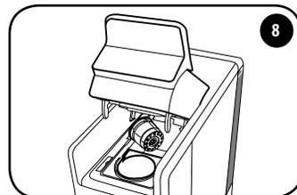
Para ejetar a cápsula utilizada, eleve lentamente a alavanca e a cápsula será coletada automaticamente no recipiente apropriado. Se a cápsula não for ejetada, repita a operação.
