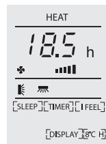
Εικόνα 2, Χρονοδιακόπτης απενεργοποίησης όταν η συσκευή είναι σε λειτουργία
