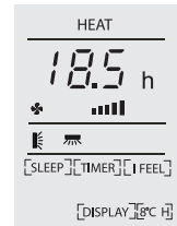
Slika 2 Tajmer za isključivanje, uz uključeni uređaj
