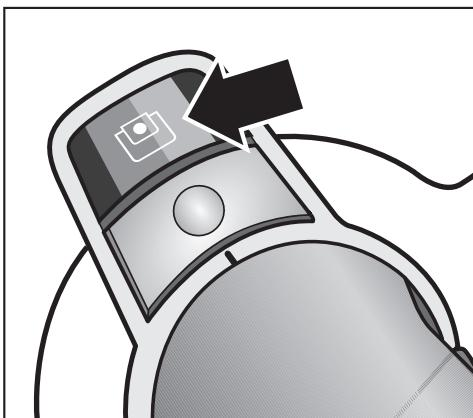
Kada se skala na providnom otvoru indikatora potrebe zamene kese za prašinu ispuni crvenom bojom, morate da zamenite kesu za prašinu.
