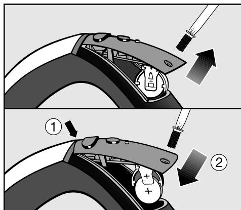
■ Krstastim odvijačem odvrnutezavrtanj za pričvršćivanje poklopca i skinite poklopac.
