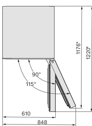
\* Dimenzije bez montiranih zidnih odstojnika. Ukoliko se koriste zidni odstojnici, povećava se dubina uređaja za 15 mm.
