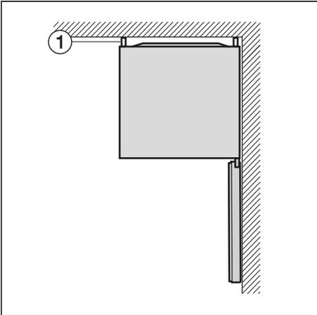
Zidni odstojnici ① na zadnjoj strani Vašeg rashladnog uređaja obezbeđuju da vlažnost koja nastaje može da se odvodi napolje.
