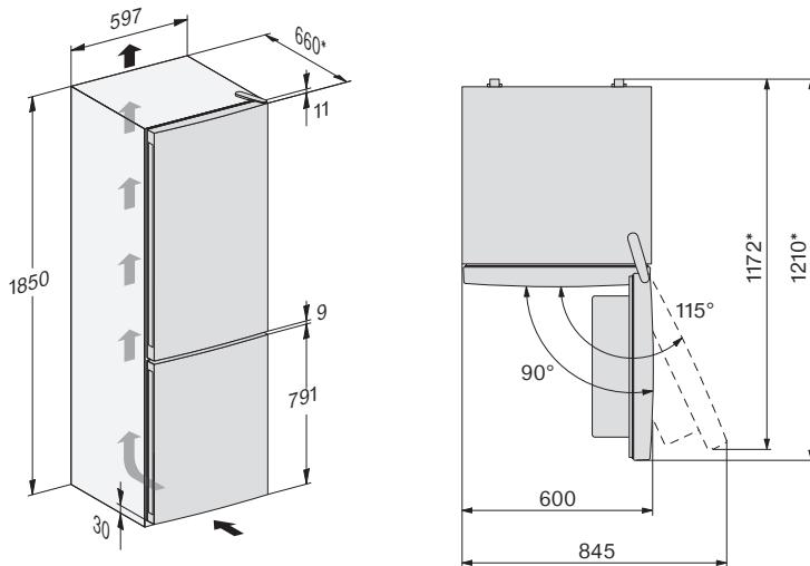
\* Dimenzija sa montiranim zidnim odstojnicima. Ukoliko se zidni odstojnici ne koriste, smanjuje se dubina rashladnog uređaja za oko 22 mm.
