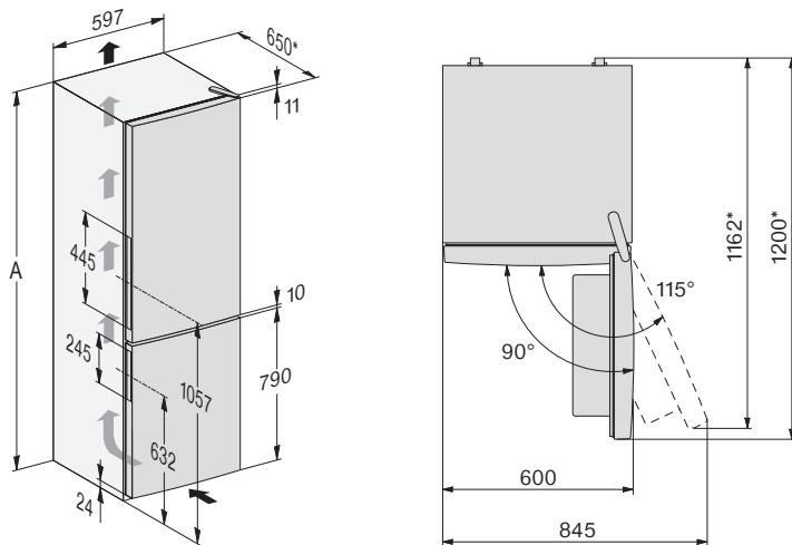
\* Dimenzije bez montiranih zidnih odstojnika. Ukoliko se koriste zidni odstojnici, dubina uređaja se povećava za oko 36 mm.
