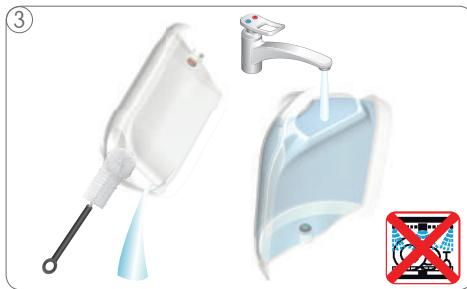
Isperite i očistite rezervoar za vodu. Nakon toga, sipajte u rezervoar svežu, pićnu vodu i vratite ga u aparat. Rezervoar za vodu ne treba prati u mašini za pranje posuđa!
