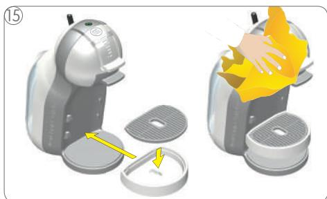
Rešetku stavite na posudu za sakupljanje iskapale tečnosti. Zatim stavite posudu za sakupljanje iskapale tečnosti na željeno mesto u aparatu. Očistite aparat mekom, vlažnom krpom. Potom ga prebrišite mekom, suvom krpom.
