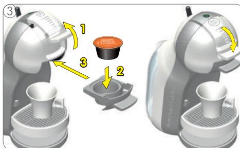
Podignite ručku za zaključavanje i izvucite držač kapsule. Stavite kapsulu u držač i držač zatim vratite u aparat. Spustite ručku za zaključavanje.
