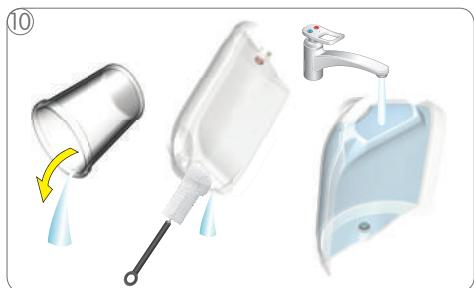
Ispraznite i očistite bokal. Isperite i očistite posudu za vodu. Potom u nju sipajte svežu, pijaču vodu i vratite je u aparat.
