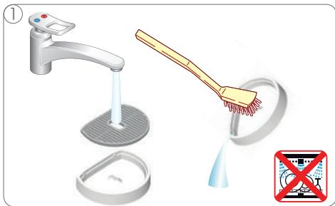
Posudu za sakupljanje iskapale tečnosti isperite vodom i očistite je četkom.
