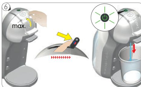
Ručicom podesite broj linija na maksimum. Pomerite/pomjerite ručicu u desno da počne ispiranje.
