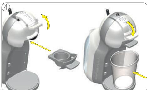
Podignite ručku za zaključavanje i stavite prazan držač kapsule. Spustiti ručicu za zaključavanje. Postavite bokal zapremine 1 litar ispod.
