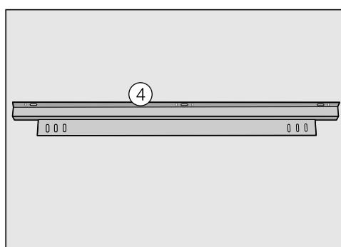
Za pričvršćivanje ploče za podešavanje potreban vam je ugaonik za fiksiranje ④. On je dostupan u Miele servisu ili specijalizovanoj prodavnici. Ugaonik za fiksiranje, u zavisnosti od potrebe, možete da montirate na vinsku vitrinu ili ispod nje:
