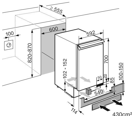
Pre ugradnje vodite računa da komora tačno odgovara navedenim ugradnim mera- ma. Obavezno se pridržavati otvora za dovod i odvod vazduha, a otvor u zaslonu postolja za priloženu ventilacionu rešetku mora biti centriran sa vinskom vitrinom, kako bi se obezbedilo pravilno funkcionisanje vinske vitrine.
