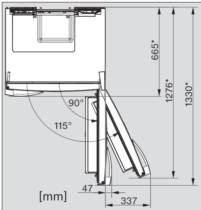
\* Dimenziije bez montiranih zidnih odstojnika. Ukoliko se koriste zidni odstojnici, povećava se dubina uređaja za 35 mm.
