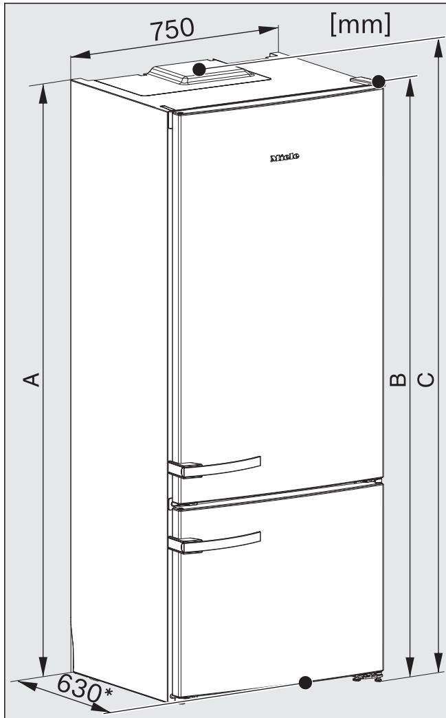
\* Dimenzije bez montiranih zidnih odstojnika. Ukoliko se koriste zidni odstojnici, povećava se dubina uređaja za 35 mm.
