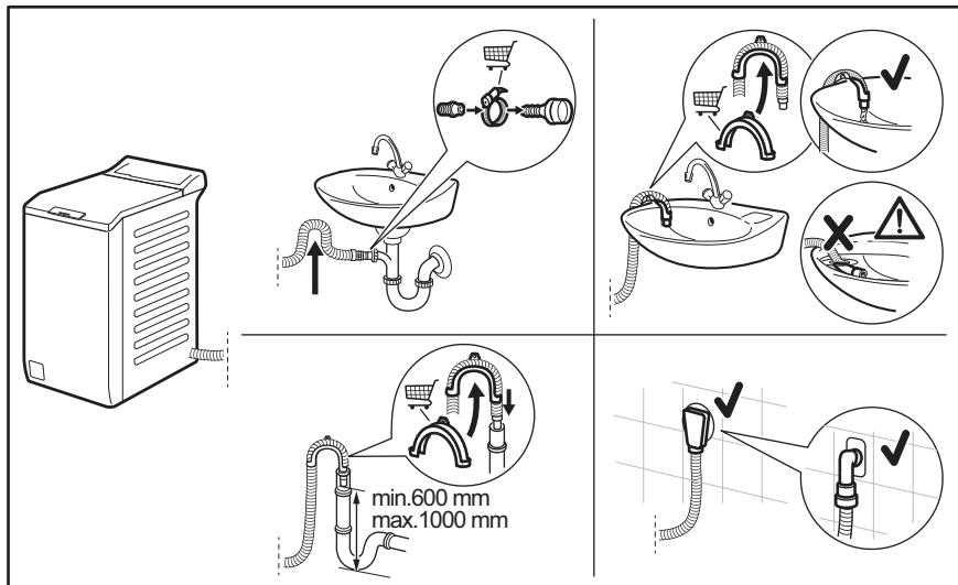
Odvodno crijevo treba biti na visini ne manjoj od 600 mm i ne većoj od 1000 mm.
