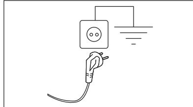
Kabel električnog napajanja nakon postavljanja uređaja mora biti lako dostupan.
