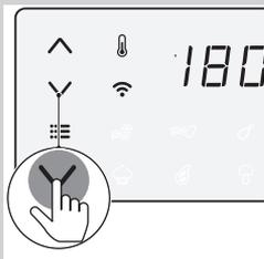
6 Pritiskajte gumb za zvišanje ali znižanje temperature, da izberete želeno temperaturo.
