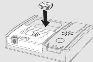
Po vlivanju detergenta v posodo zaprite vratca s pritiskom v smeri puščice, da se s klikom zaskočijo na ustreznem mestu.
