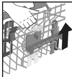
Če jo želite spustiti: košarico primite ob straneh, pritisnite dve ročici B ob straneh košarice in jo spustite.
