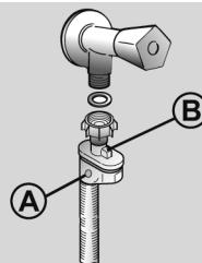
● **AQUAPROTECT, DOVODNA CEV SA ZAŠТИТОM** (sl. 6): Ako glavna unutrašnja cev "A" curi, voda će se zadržati u providnoj zaštitnoj cevi "B" kako bi se omogućilo da se ciklus pranja u potpunosti završi. Nakon završetka pranja, kontaktirajte ovlašćeni servis kako biste zamenili dovodnu cev.
