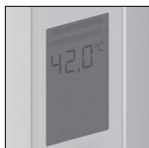
Wyświetlacz pokazuje aktualny stan pracy i umożliwia dokonywanie ustawień z poziomu menu oraz odczytywanie parametrów zużycia.
