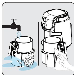
Očistite fioku za korpe (6) i uklonjivu korpu za kuvanje (7) toplim vodom sa saponom, a zatim dobro osušite spoljašnju površinu uređaja i delove koje ste upravo oprali.
