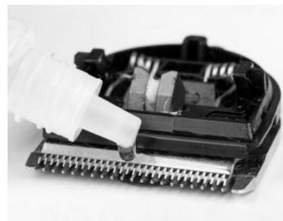
**Važno:** kako bi obezbedili dug radni vek uređaja važno je da glavu oštrice redovno uljite. Kod nedostatka uljnog filma dolazi do trljanja metala od metal te glava oštrice se brzo troši.
