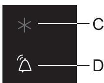
U slučaju previsoko narasle temperature u aparatu, uključi se zvučni alarm (isprekidani ton) i trepće simbol **D**.
