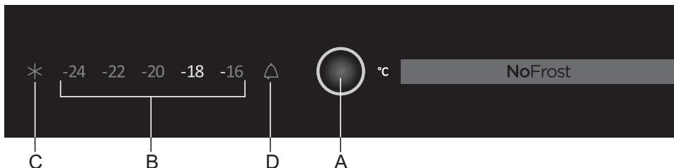
A Taster za regulisanje temperature i uključenje intenzivnog zamrzavanja
