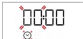
Uporabite + ali - za nastavitev ure in pritisnite za potrditev. Števki za minute začneta utripati. Uporabite + ali - za nastavitev minut in pritisnite za potrditev.
