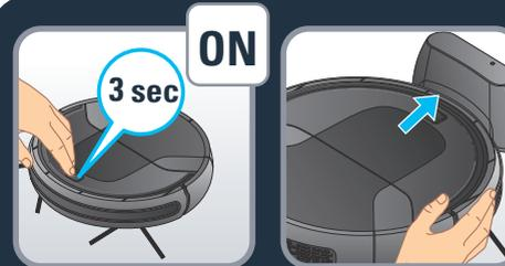
**FR** Pour charger le robot, allumez-le en appuyant sur le bouton marche / arrêt pendant 3 secondes. Placez le robot sur la station d'accueil : les plaques de charge du robot doivent toucher celles de la station d'accueil.
