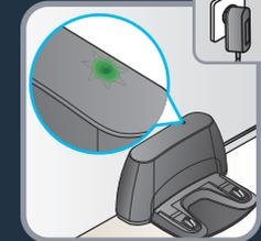
**FR** Branchez l'adaptateur secteur dans la prise d'alimentation située sur le côté de la base. Utilisez uniquement le chargeur fourni avec le robot: n'utilisez pas de chargeur universel. Branchez le câble d'alimentation à une prise secteur. Lorsque le câble d'alimentation est branché, vérifiez si l'indicateur vert est allumé sur la partie supérieure de la base.
