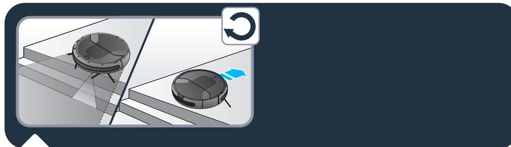
**FR** Le robot dispose de capteurs de chute pour détecter les escaliers et les vides. Le robot changera de direction lors de la détection. Afin de détecter correctement la différence de niveau du sol, assurez-vous qu'il n'y a pas d'objets (sacs, chaussures, etc.) sur le sol près des espaces vides, des escaliers ou des marches. La marche doit faire plus de 10 cm pour être détectée.
