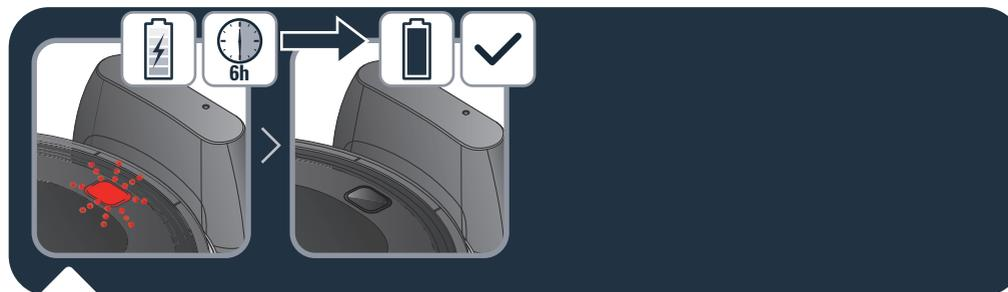
**FR** Lorsque le bouton marche / arrêt clignote, le robot se charge. Lorsque le bouton marche / arrêt cesse de clignoter, le robot est complètement chargé (6h pour que la batterie soit complètement chargée).
