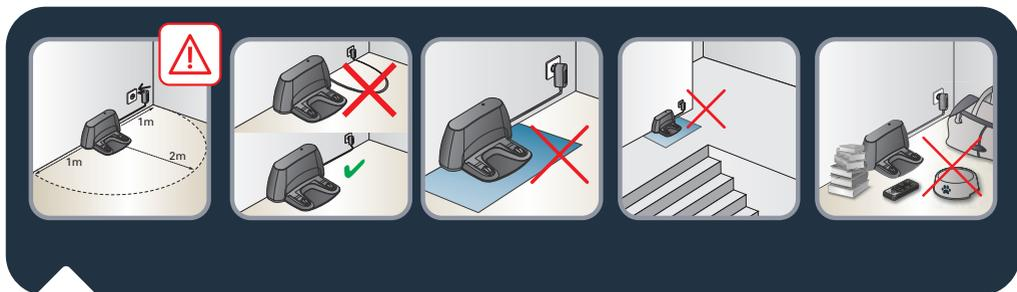
**FR** Pour placer la base de charge, assurez-vous qu'il y a un espace vide de 1 m sur le côté et 2 m en face de la base de charge. N'installez pas la base de charge près d'un escalier. Le câble doit être serré. Placez toujours la station d'accueil sur un sol dur. Ne placez pas la base de charge sur un tapis.
