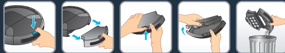
**FR** Le robot doit être vidé et nettoyé au moins une fois par semaine. Appuyez sur le bouton à l'arrière du robot et sortez le bac à poussière. Pour le vider, retirez le couvercle.
