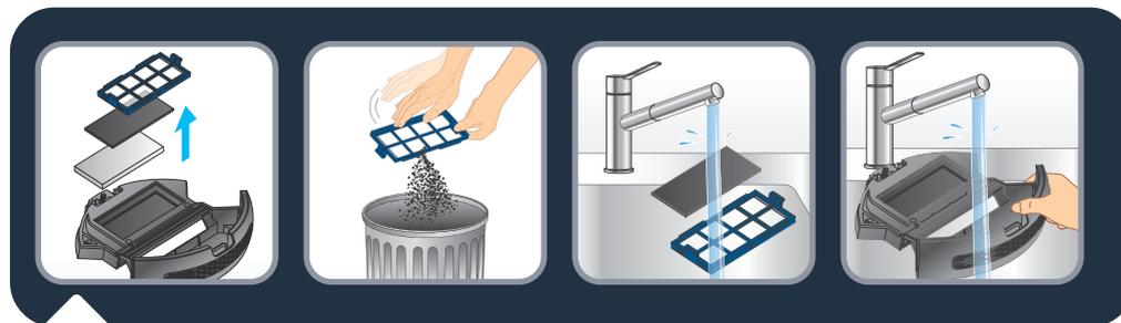
**FR** Pour nettoyer les filtres, retirez-les du bac à poussière. Nettoyez la grille du filtre en tapotant l'arrière au-dessus d'une poubelle. Lavez le filtre en mousse, la grille du filtre et le bac à poussière à l'eau claire. Ne mouillez pas le filtre à poussière fin (filtre blanc).
