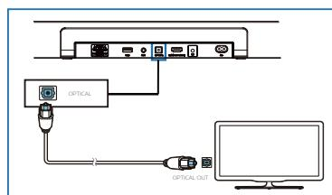
Koristeći optički kabl povežite **OPTICAL** priključak na zvučniku Soundbar sa **OPTICAL OUT** priključkom na TV-u ili drugom uređaju.
