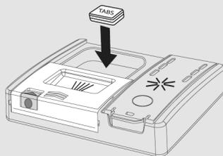
Po vlivanju detergenta v posodo zaprite vratca s pritiskom v smeri puščice, da se s klikom zaskočijo na ustreznem mestu.
