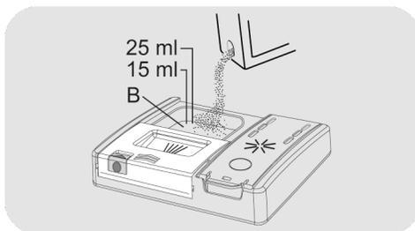
Ako koristite tablete, jedna bi trebalo da bude dovoljna. Ubacite TABLETE pazeći da ne ometaju sistem otvaranja.
