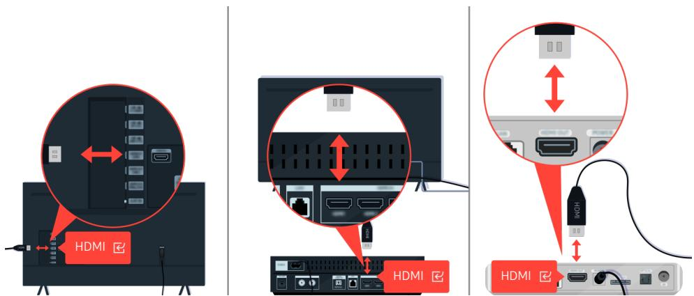
Najprije isključite pa ponovno priključite kabele napajanja i HDMI kabele na stražnju stranu televizora ili uređaja One Connect, zatim isključite kabel napajanja i ponovno ga uključite u zidnu utičnicu.
