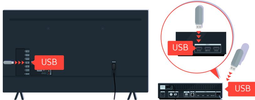
Umetnите USB uređaj u USB priključak na zadnjoj strani TV uređaja ili na bočnoj strani uređaja One Connect.
