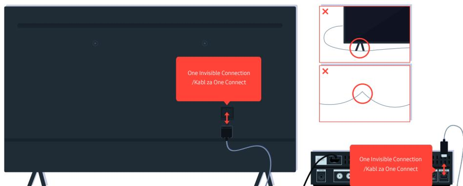
Izvucite i ponovo priključite One Invisible Connection ili Kabl za One Connect između TV uređaja i uređaja One Connect. Pobrinite se da One Invisible Connection ili Kabl za One Connect ne budu priklešteni ili savijeni pod oštrim uglom.
