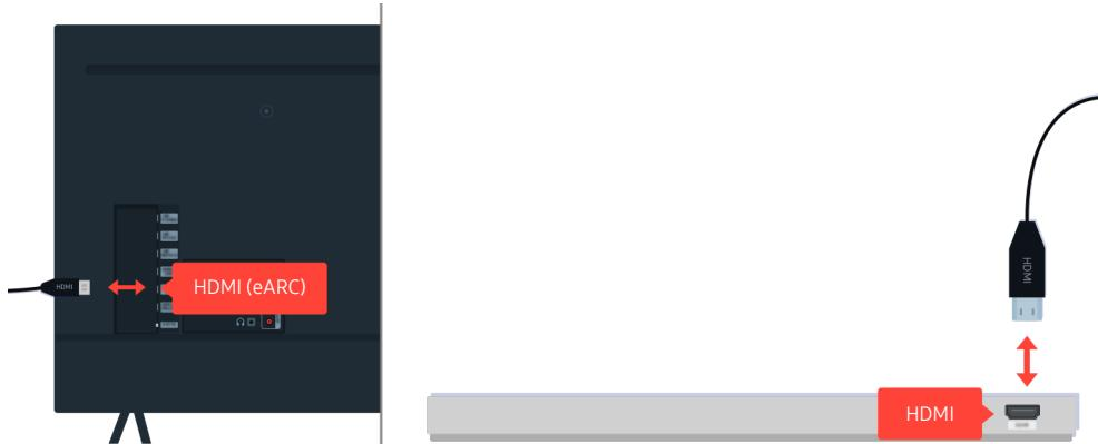
Ako se iz sound bar zvučnika ne čuje zvuk i ako je on povezan sa TV uređajem preko HDMI kabla, proverite HDMI (eARC) konektor na zadnjoj strani TV uređaja.
