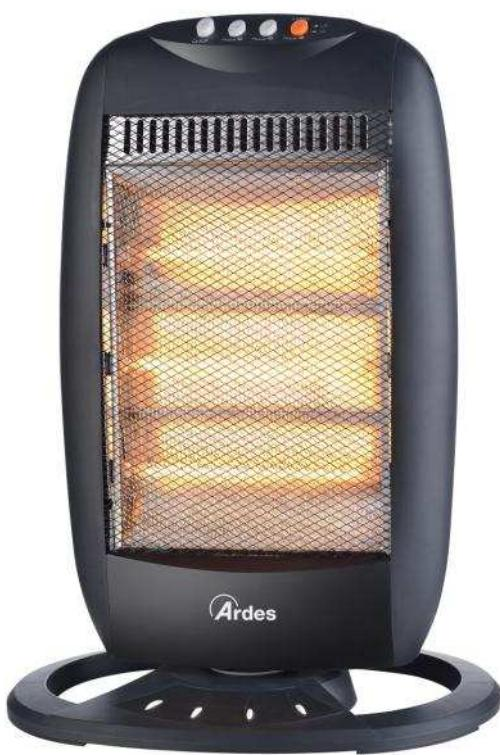
Stufa alogena con 3 elementi riscaldanti. 3 livelli di potenza selezionabili individualmente: 400/800/1200W. Oscillazione orizzontale. Interruttore anti ribaltamento. Colore nero. Resa 40 m<sup>3</sup>.
