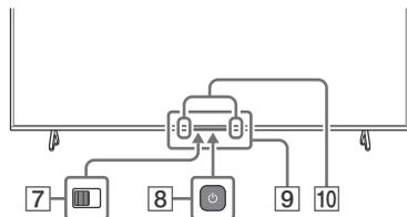
**7** **BUILT-IN MIC SWITCH**\*<sup>1</sup> **(Preklopni gumb vgrajenega mikrofona)**: Vključite/izklopite vgrajeni mikrofona.
