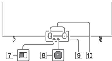
**7** **BUILT-IN MIC SWITCH\*1 (Integruoto mikrofono jungiklis):** Įjunkite / išjunkite įmontuotą mikrofoną.
