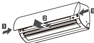
**2** Pritisnite dugme **ON/OFF** i držite ga 6 sekundi nakon čega će jedinica dva puta ispuštiti zvuk, a lampica će 4 puta trepereti po dva puta.
