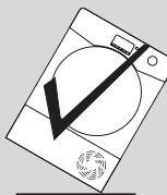
Ukoliko je uređaj bio okrenut na drugačiji način, pričekajte barem 4 sata prije uključenja, kako bi se ulje vratilo u kompresor i stabiliziralo. U suprotnom, može doći do oštećenja kompresora.
