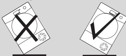
U slučaju da ste okrenuli proizvod u suprotnom smeru, sačekajte najmanje 4 sata pre uključivanja tako da ulje može da se vrati pravilno u kompresor. U suprotnom, može doći do oštećenja kompresora i prestanka rada mašine.
