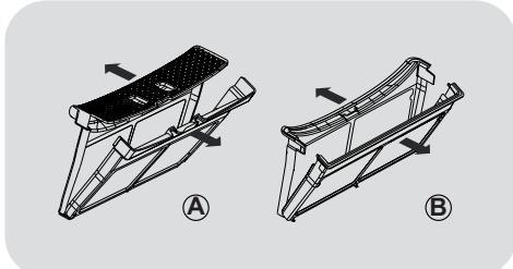
3. Nježno uklonite vlakna iz obaju filtera služeći se vrćima prstiju ili mekom četkom, krpom ili pod tekućom vodom.
