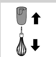
**10** Da biste odvojili mutilicu od jedinice za povezivanje, izvucite mutilicu iz jedinice za povezivanje pravo nadole.
