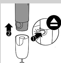
**9** Pritisnite dugme za otpuštanje da biste odvojili jedinicu motora od jedinice za povezivanje mutilice.
