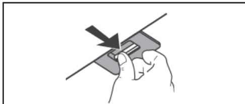
Az aktív szén-szűrő se nem tisztítható és se nem újítható fel, ezért kb. 4 havonta (illetve intenzív használat esetén sűrűbben) cserélni kell.
