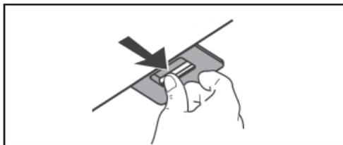
Aktivní filtr z dřevného uhlі není vhodný pro čištění a obnovu a je nutné ho měnit cca. každé 4 měsíce provozu nebo častěji, a v případě zvláště intenzivního používání ještě častěji.
