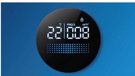
Senzor za kvalitet vazduha detektuje čestice u vazduhu manje od 2,5 µm i rezultate prikazuje
