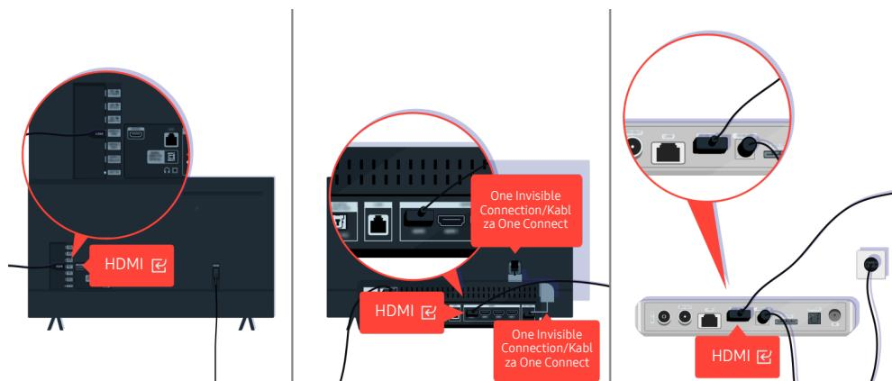
Proverite vezu HDMI kabla i televizora ili uređaja One Connect.
