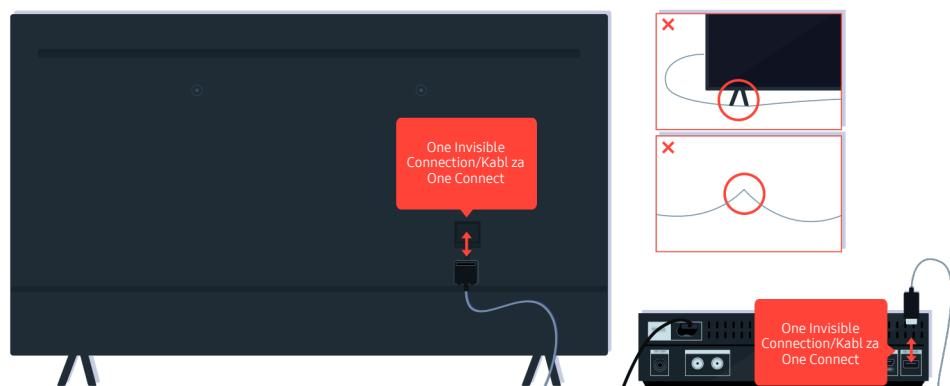
Izvucite i ponovo priključite One Invisible Connection ili Kabl za One Connect između televizora i uređaja One Connect. Pobrinite se da One Invisible Connection ili Kabl za One Connect ne budu priklešteni ili savijeni pod oštrim uglom.
