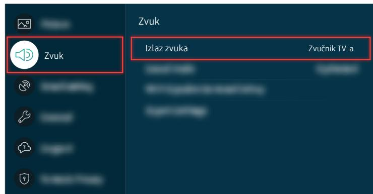
Proverite jačinu zvuka na ekranu. Ako nije prikazan broj za jačinu zvuka, izaberite > **Podešavanja** > **Zvuk** > **Izlaz zvuka**. Zatim izaberite **Zvučnik TV-a**.
