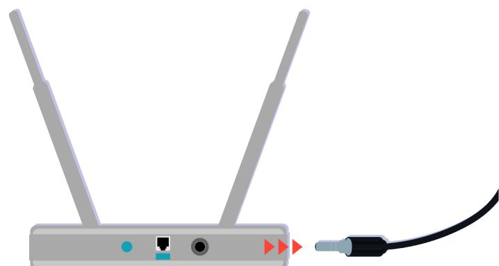
Ponovo pokrenite pristupnu tačku tako što ćete izvući pa ponovo priključiti konektor za napajanje. Nakon ponovnog pokretanja može biti potrebno 1 do 2 minuta dok pristupna tačka ponovo uspostavi vezu sa internetom.
