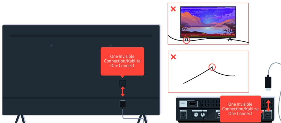
Ako se problem i dalje javlja i ako televizor koristi One Invisible Connection ili Kabl za One Connect, izvucite i ponovo priključite One Invisible Connection ili Kabl za One Connect na televizor i uređaj One Connect. Pobrinite se da One Invisible Connection ili Kabl za One Connect ne budu priklešteni ili savijeni pod oštrim uglom.
