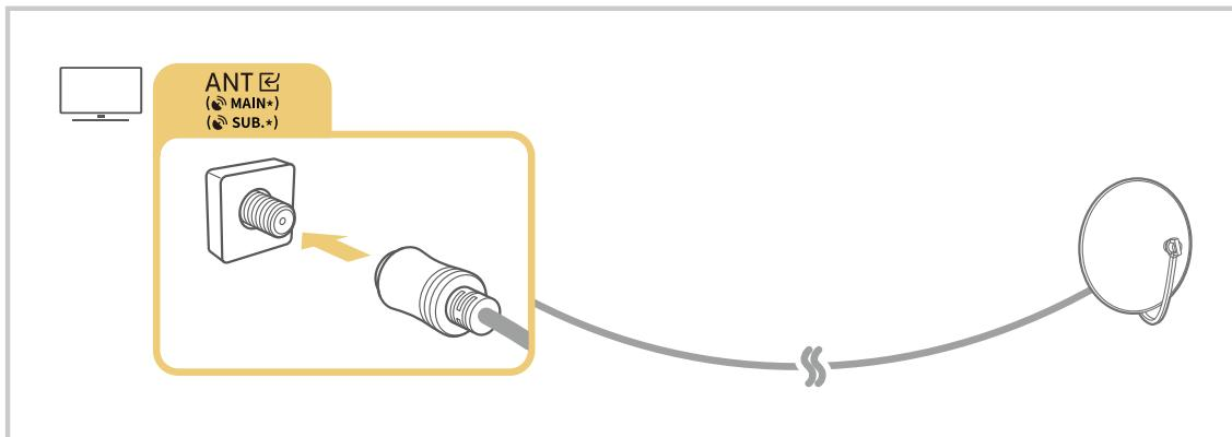
Preporučujemo da oba priključka povežete koristeći Multi-Switch ili DiSEqC Switch itd. i da [Tip priključka za antenu](#) podešite na [Dva ulaza](#).
