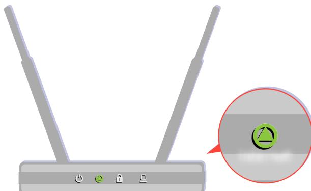
Uverite se da pristupna tačka radi ispravno. Proverite LED indikatore na pristupnoj tački da biste se uverili da radi ispravno.
