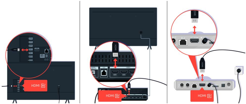
Proverite da li su antena i HDMI kabl pravilno priključeni.
