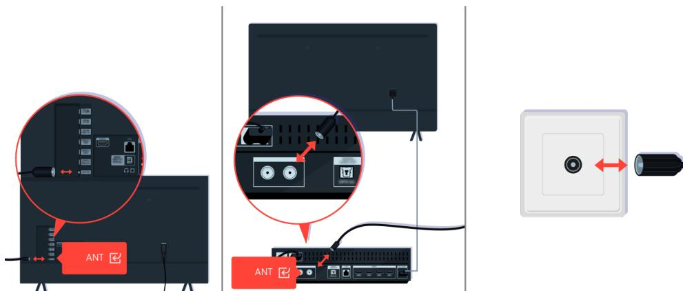
Proverite da li su antena i kabl za ulazni signal pravilno priključeni.
