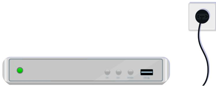
Ako se ne uključuje, uverite se da je kabl za napajanje pravilno povezan sa uređajem i sa zidnom utičnicom.
