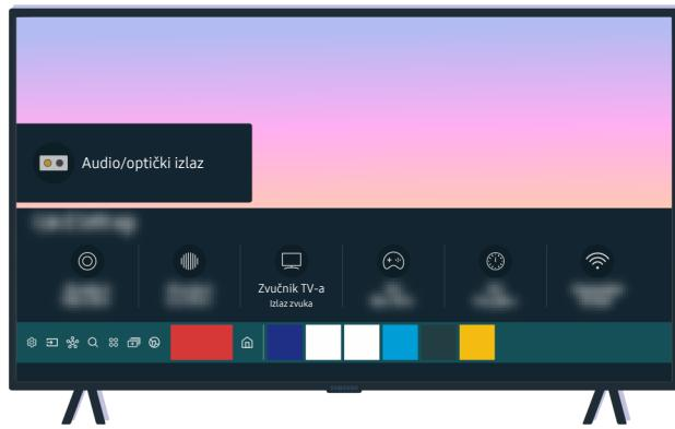
Proverite jačinu zvuka na ekranu. Ako nije prikazan broj za jačinu zvuka, izaberite > **Podešavanja** > **Zvuk** > **Izlaz zvuka**. Zatim izaberite **Zvučnik TV-a**.
