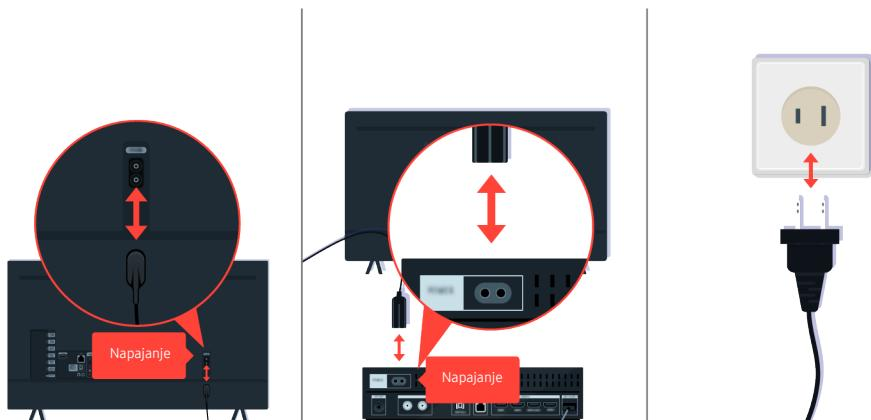
Prvo izvucite pa ponovo povežite kablove za napajanje i HDMI kablove na zadnjoj strani televizora ili uređaja One Connect, a zatim izvucite kabl za napajanje iz zidne utičnice i ponovo ga priključite.
