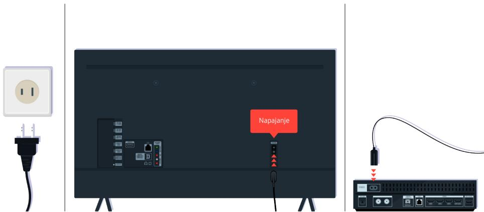
Ako senzor daljinskog upravljača nije uključen, izvucite kabl za napajanje pa ga ponovo povežite.
