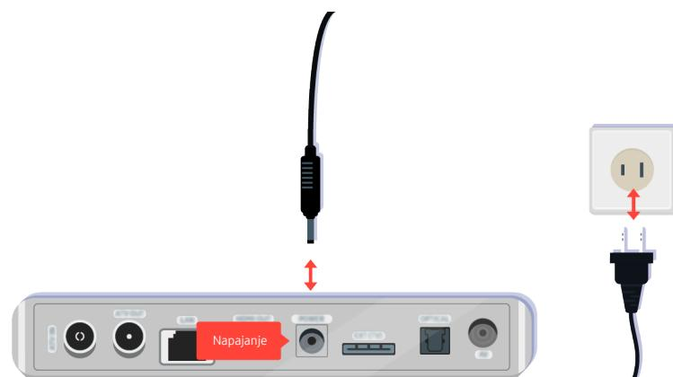
Ako se ne uključuje, uverite se da je kabl za napajanje pravilno povezan sa uređajem i sa zidnom utičnicom.
