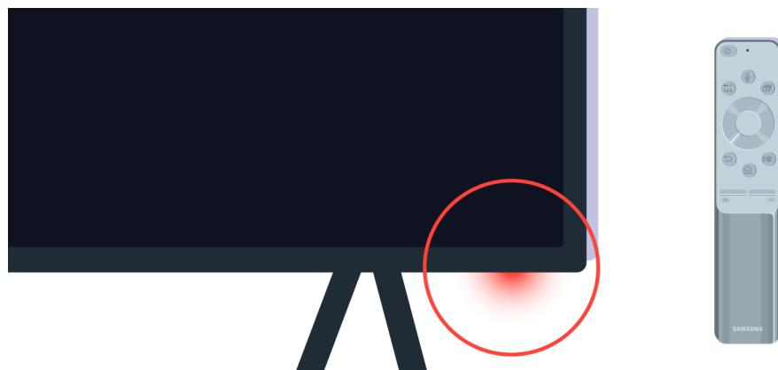
Još jednom proverite senzor daljinskog upravljača. Ako LED lampica svetli, pritisnite dugme za uključivanje/isključivanje na daljinskom upravljaču da biste uključili televizor.
